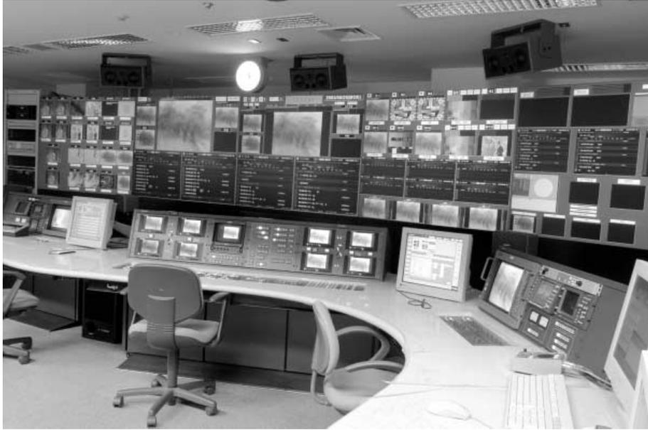
図1．地上デジタル放送マスタ送出システムの監視室 - アナログ放送とデジタル多チャンネル放送の同時放送が可能である。(写真は、讀賣テレビ放送(株)への納入システム。)
