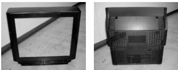
図7. リサイクル材で製作したテレビキャビネット - テレビキャビネットの廃プラスチックから製作したもので、組込み試験も良好でクローズドリサイクルが可能になった。
