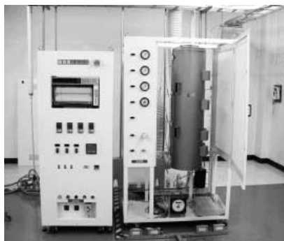
図5．固定床反応基礎特性試験装置 - セラミックス吸収材の吸収材ペレットを充填した固定床反応器で、反応温度、反応圧力、ガス組成、ガス流量をパラメータに反応基礎特性を調べる。
