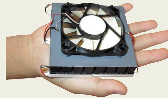
図3. 自己冷却システムの外観 - 手のひらの体温と室温の温度差により発電が可能です。
