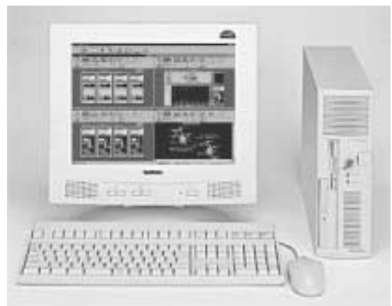
図2. 更新HMIの構成機器 - 更新HMIのサイズをコンパクト化するため、スリム型産業用PCと液晶モニターで構成した例を示す。 Configuration of renewed human-machine interface (HMI)
