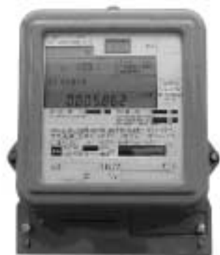
図4. 電力需給用複合計器(通信機能付, サイクリック表示) - 最近開発された高圧用計器で、一つの液晶ディスプレイにより多項目の計測アイテムをサイクリック方式で表示する。
