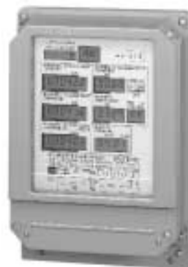
図1. 実量制計器 - 88年に電子式計器として初めて導入されたもので、実量制度が開始された高圧500kW～50kWの領域に設置された。
