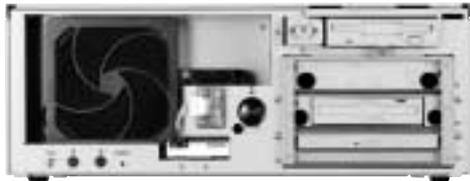
図3 . FA3100A model 8000/8010 内部前面の実装例 - HDDなどのプラグイン実装方式や寿命部品の前面集中配置を採用しており, メンテナンスが容易に行える。
