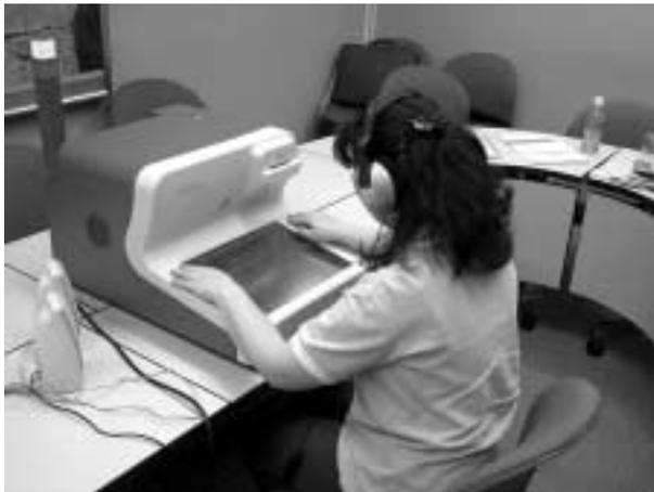
図3 . (社福)日本点字図書館での1次モデル評価 - 全盲の人が、触覚記号とタッチパネルを使って、音声ガイドに従って投票し、サポートなしで投票できることを確認した。
