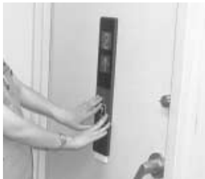
図6. のりば操作盤の原寸大サンプルを使用した評価状況 - 原寸大ののりば操作盤を使用して、視覚障害者にボタンの触知性についてヒアリングした。
