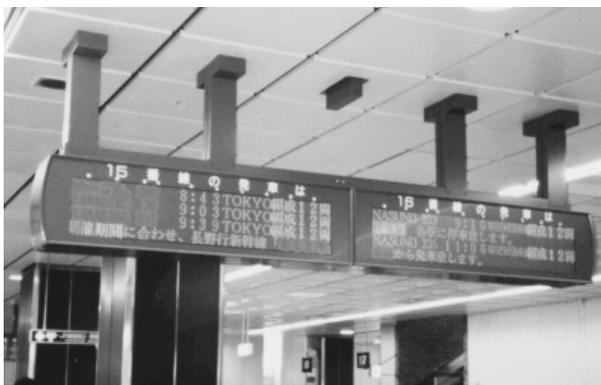
図1. 旅客案内表示装置の外観 - 駅のホームに設置されている旅客案内表示装置。行き先案内表示、時刻表示などを行う。
