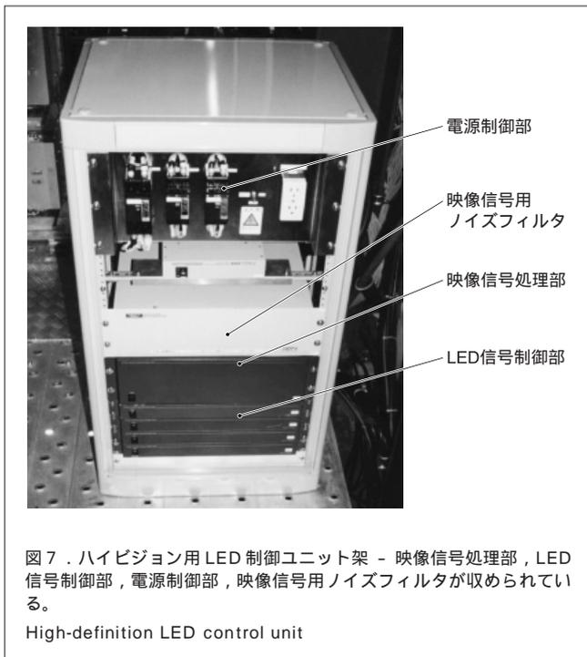
図7. ハイビジョン用LED制御ユニット架 - 映像信号処理部, LED信号制御部, 電源制御部, 映像信号用ノイズフィルタが収められている。
