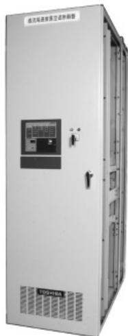
図4. 直流高速度真空遮断器 - 遮断部に真空バルブを使用し、転流コンデンサからの逆電流を重畳させ、電流0点を形成し、消弧装置で遮断エネルギーを吸収して遮断する。 High-speed vacuum circuit breaker
