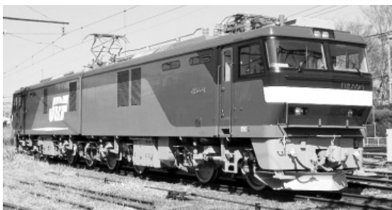
図5 . EH500 形交直流電気機関車 - 4,520 kW の出力を備え、青函トンネル走行も可能な交直流電気機関車である。 Type EH500 AC/DC electric locomotive
