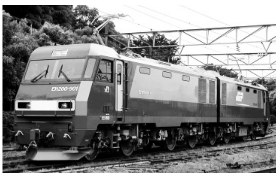
図7.EH200形直流電気機関車 - 直流電化勾配線区向けに開発された,短時間最大出力5,120kWを備える直流電気機関車である。 Type EH200 DC electric locomotive
