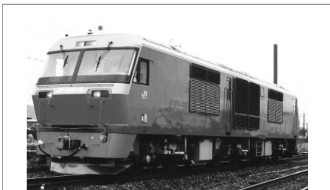
図2 . DF200 形電気式ディーゼル機関車 - 1,800 PSディーゼルエンジン発電機2台を搭載した、インバータ駆動方式のディーゼル機関車である。 Type DF200 diesel-electric locomotive
