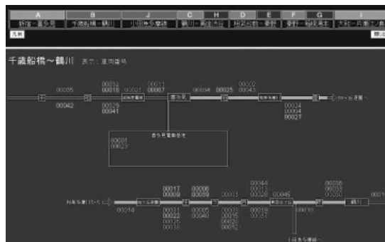
図2 . 位置管理端末の表示画面 - 車両位置検知システムで検知した車両位置を、従来の区間単位で表示している。
