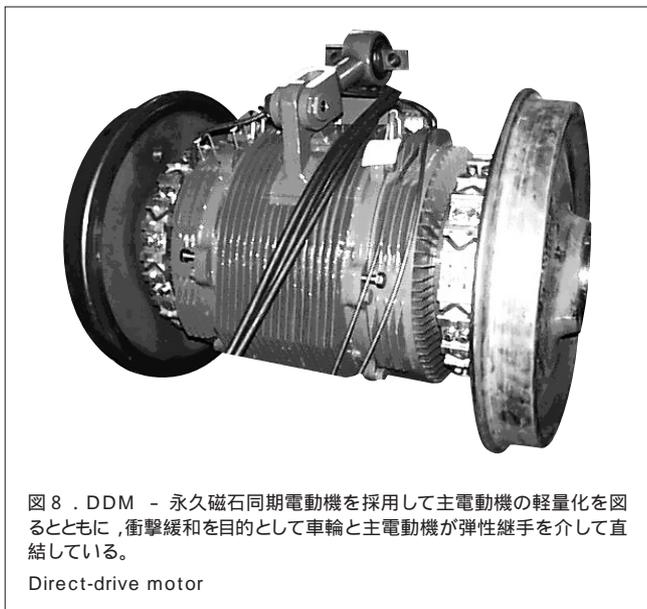
図8 . DDM - 永久磁石同期電動機を採用して主電動機の軽量化を図るとともに、衝撃緩和を目的として車輪と主電動機が弾性継手を介して直結している。
