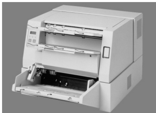
図4. 卓上型高速イメージスキャナ S3000 - クリアフォルダに挟んだ帳票、シーリングはがきなどの厚紙、及びノンカーボン紙などの薄紙を、いずれも安定して搬送することができる。
