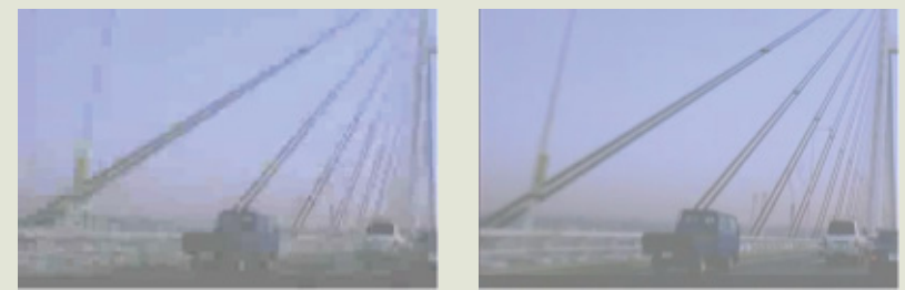
図2. 当社提案の適応重み補間予測 - 従来の方式では直前のフレームの明るさが基準になるので、実際のフレームの明るさとの差がノイズとなる。一方、提案方式では複数の参照フレームに適応的に重み係数を掛けて予測に使うため、明るさが時間的に変化するフェード画像などで性能が大幅に向上する。
