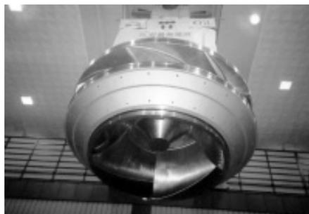
図3: 東京電力(株)安曇発電所向け スプリッタポンプ水車ランナ - 世界初のフランシス形スプリッタポンプ水車ランナである。
