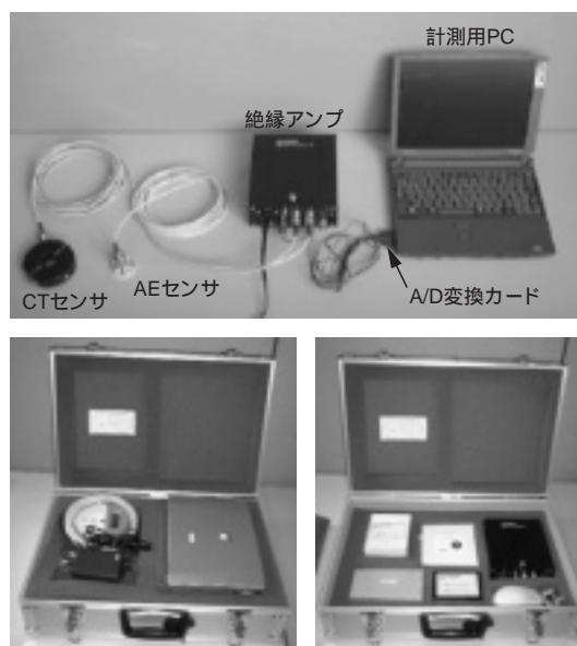
図1. 可搬形部分放電検出装置 - 上が使用時の配線状態で、下が収納状態である。アタッシュケースの2段収納で持ち運びが容易である(全質量6kg)
