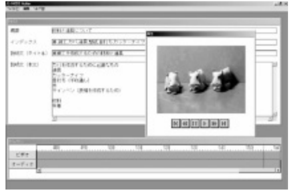
図7. オーサリングツール - 映像や音声データから必要なシーンを切り出し、タイトル、説明文、関連情報へのリンクを付加して、マルチモーダルナレッジを作成する。
