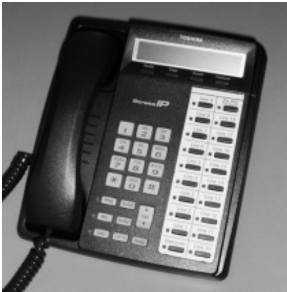
図2 . IP 電話機 IPT1020-SD - 当社独自開発のIP化された多機能電話機である。
