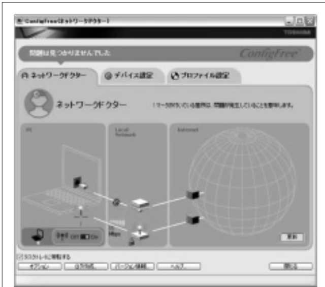
図5. ConfigFree™ Connectivity Doctorの診断画面 - ConfigFree™ Connectivity Doctorで接続状態を診断した結果の例である。 Diagnostic result display screen of Connectivity Doctor utility in ConfigFree™
