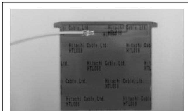
図3 . デュアルバンドアンテナ素子 - 銅板 30 mm × 30 mm × 0.2 mm ) の両面に絶縁体フィルムをはり付けた構造である。
