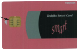
高品質乱数と擬似乱数(一例)の比較(上図)と、乱数生成回路が搭載されるICカード用マイコン Comparison of high-quality random numbers and pseudo random numbers (top), and IC card equipped with high-quality random number generator (bottom)
