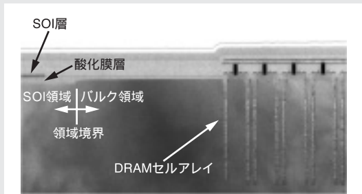
SOIウェーハ上DRAMの断面構造 Cross-sectional image of SOI-DRAM
