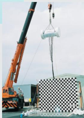
1/3キャスク試験体による9 m落下試験
