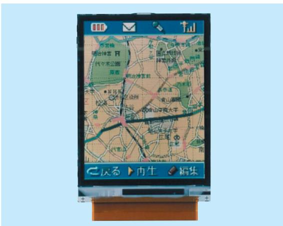
携帯電話用 2.2型QVGA TFT-LCD LTM022P806
