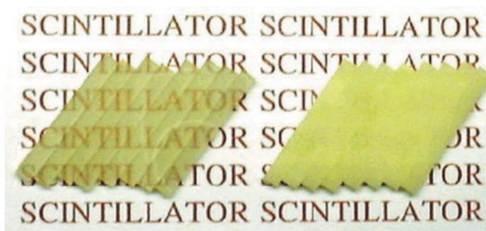
Gd<sub>2</sub>O<sub>2</sub>S:Prセラミックシンチレータ(左:開発品 右:在来品)
