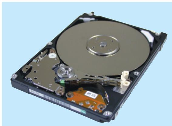
2.5型HDD MK6021GASの内部構造
