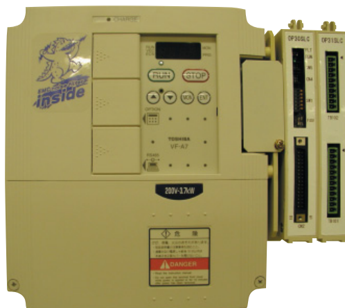
インバータ装置の右側に装着された舞台機構位置決めコントローラ Stagecraft position controller mounted on right side of inverter unit
