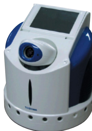
ホームロボットの外観(320(直径)×380(高さ)mm) Overview of home robot
