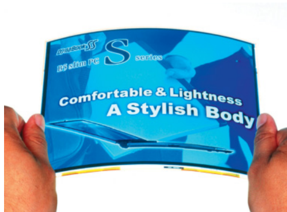
曲がる大画面低温ポリシリコンTFT-LCD Bendable low-temperature polysilicon TFT-LCD
