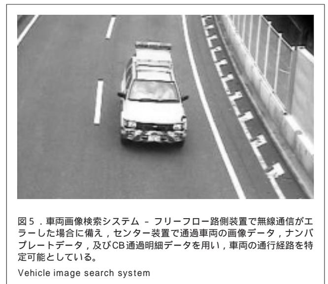
ナス明細があがらないケースがありうる。また、万一不正な利用者が本来割引対象でない経路を通行したにもかかわらず、通行経路を偽って割引の申立てを行うケースも考えられる。そのため、ポイントとなる本線上や対象出路に画像読取装置及びナンバプレート自動読取装置を設置し、センター装置に自動収集することにより、問合せ時の利用者走行を特定する検索システムを構築した(図5)。
