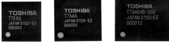
図5 . チップセット - 左からミックストシグナルLSI( 11 mm × 11 mm ,241ピン),コントロールLSI( 13 mm × 13 mm ,284 ピン),モデム LSI( 15 mm × 15 mm ,281 ピン)で,いずれもFBGA( Fine pitch Ball Grid Array)パッケージである。
