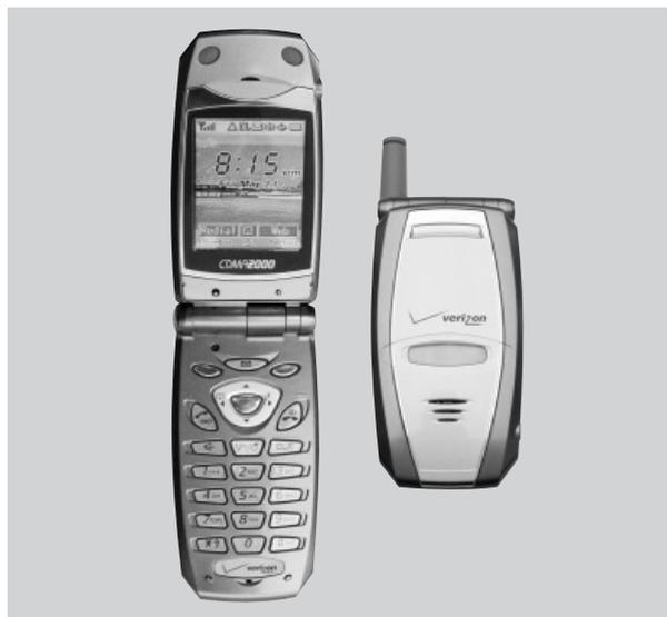
図1. CDM-9500 の外観 - 2.1 インチの高精細低温ポリシリコン TFT LCD を採用している。サブ LCD の搭載により、閉じているときでも端末の状態が容易に確認できる。
