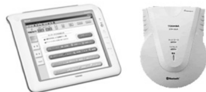
図2. ITホーム端末とITアクセスポイント - 家庭用ネットワーク機器のITホーム端末(左)とITアクセスポイント(右)を示す。 Home network terminal and home network access point
