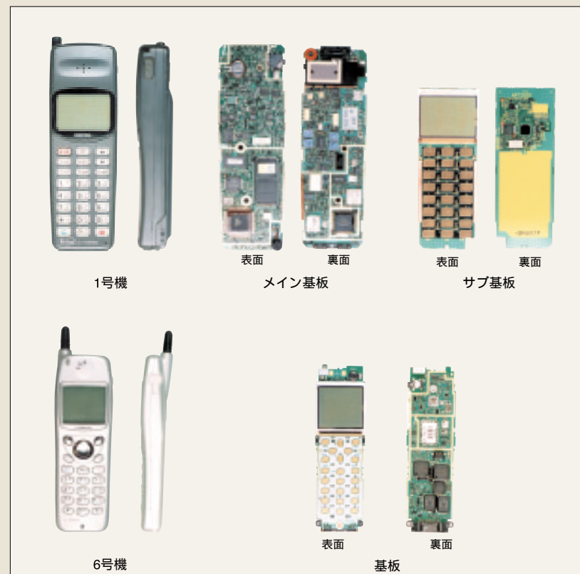
図2. PDC方式携帯電話の基板の変遷 - 当社のPDC(Personal Digital Cellular)方式の携帯電話と基板の変遷を示しています。1号機(94年)は2枚の基板で構成していましたが、6号機(99年)では高密度実装により1枚の基板に収めることで小型・薄型化を実現しました。
