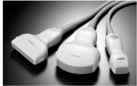
図 2. 超音波プローブの例 - 部位ごとに 15 種の形状・特性の異なるプローブを用意している。左から、表在用高周波リニアプローブ、腹部凸プローブ、循環器用セクタプローブの例を示す。 Ultrasound transducers
