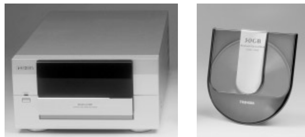
図2. 次世代大容量光ディスク装置試作機の外観 - 30 Gバイト/面のディスク(右)及び装置(左)を試作し、2002年1月に米国のCESにてデモを行った。
