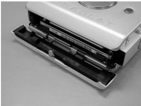
図2. スロットカバーを開けたようす - モバイルディスクの着脱のためスロット構造とした。スロットカバーの内側に黒い衝撃吸収材が見える。 Appearance with slot cover open
