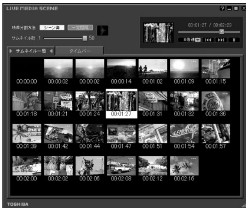
図4 . LIVE MEDIA™ for TransCube™10 アプリケーション - PC側のTV映像データ管理・再生アプリケーションの画面例を示す。見たい画面へ即座にジャンプすることが可能である。
