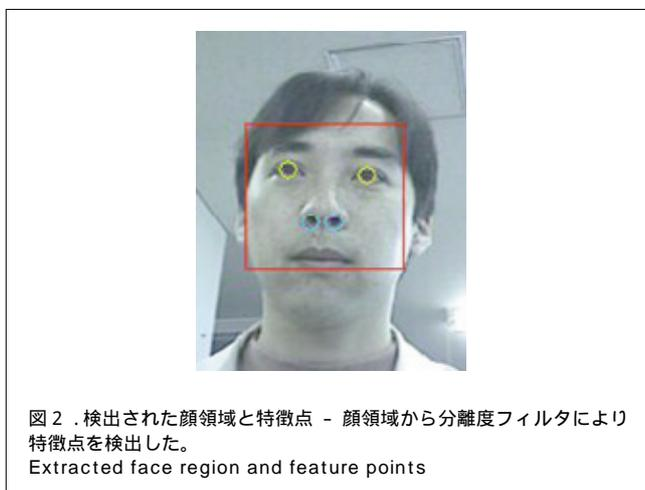
て検出する。検出された特徴点候補には、目じりや目がしら、まゆなどの余分な点が含まれるため、部分空間法を用いてパターン照合することによりこれらの点が正しいか否かを検証する。形状とパターン情報を両方考慮することで、顔の向きや照明の変化の影響に対して安定に顔の特徴点を検出できる。次に、検出された特徴点を基準とした二次元アフィン変換<sup>(注1)</sup>により、顔領域を一定の大きさ、向きに正規化し矩形(くけい)パターンとして切り出す。
