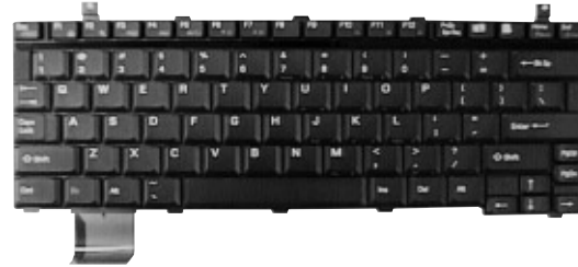
図7 . 薄型キーボード - 十分なキーピッチとキーストロークを確保しているため ,操作感が良い。 Keyboard unit
