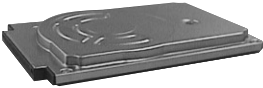
図4 . 1.8 型 HDD - 2.5型と比較して ,サイズが小さく消費電力も小さい。 1.8-inch HDD
