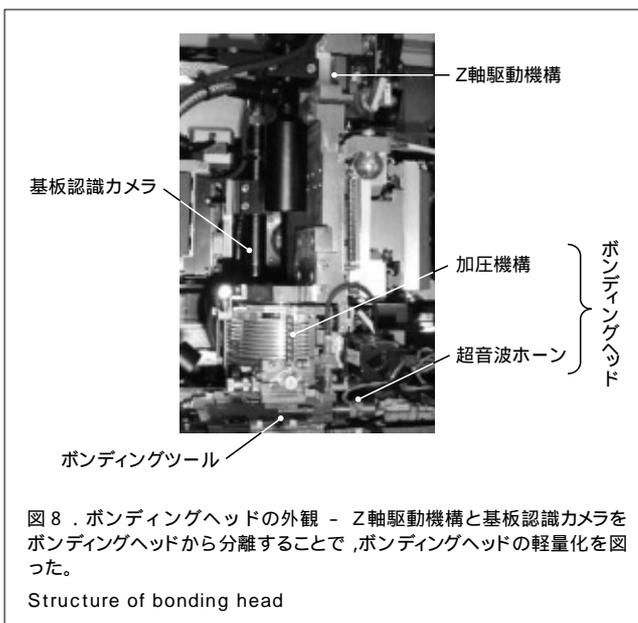
ホーン、ボンディング荷重を発生する加圧機構で構成される。
