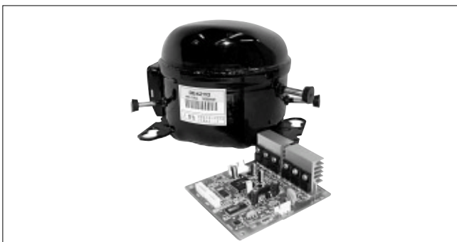
図8. 冷蔵庫用圧縮機とIPDU™ - 3シャント方式の採用でIPDU™基板の外形寸法は95 x 97.5 mmと従来に比べ約50%小型化できた。 Compressor and IPDU™ for refrigerator
