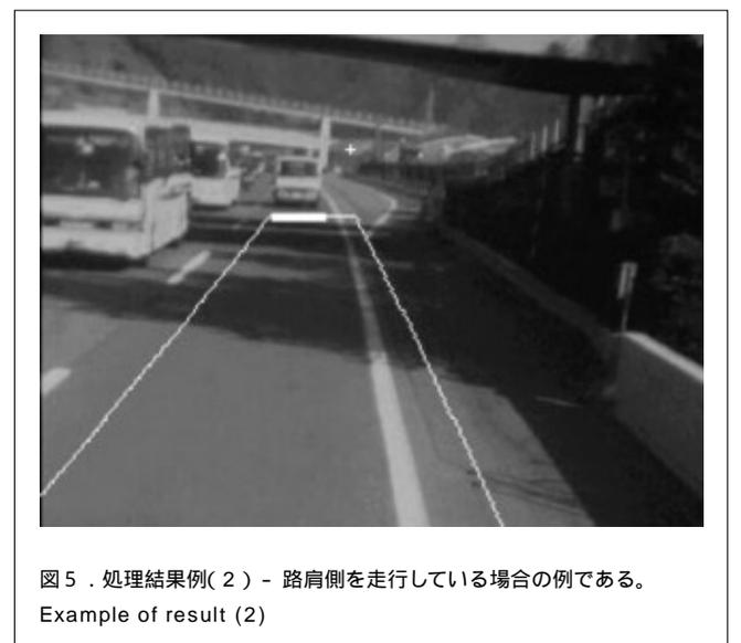
図4は追越車線の中央分離帯脇を走行している場合で、図5は走行車線側路肩を走行している場合である。
