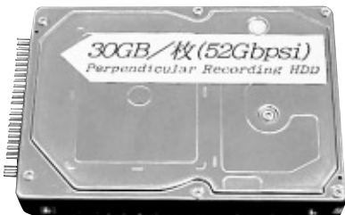
垂直記録HDD試作機(52 Gビット/in 2 )
