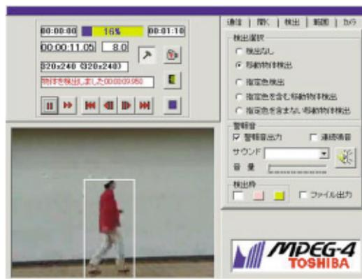
図4. 移動物体検出 移動する人物を物体として検出しており、白い枠が検出枠である。
