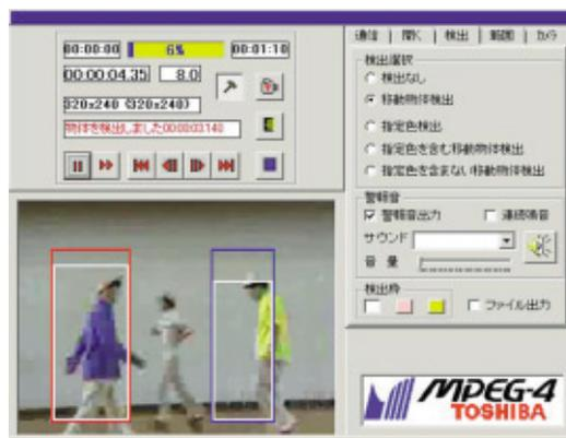
図6. 範囲を指定した検出 赤と青の枠の中だけが検出範囲で、赤い枠内と青い枠内に入った移動物体だけを検出している。
