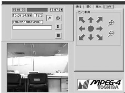
図7. 遠隔のカメラコントロール画面 カメラのコントロールパネル画面で、矢印ボタンをクリックするとその方向に移動する。+ ボタンでズーム、- ボタンでワイドになる。
