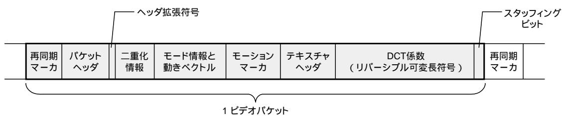
図1 . MPEG-4の誤り耐性ツール - 1ビデオパケット単位でのMPEG-4の誤り耐性ツールのデータ構造を示す。 Error-resilient tools for MPEG-4
