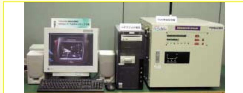
図2 .ハイブリッドMMAC試作機 右側がHiSWANa(5 GHz)受信機で、中央はネットワークを制御するパソコン(PC)本体です。PCカードスロットにはPHSカードが挿入されています。左側はモニターです。
