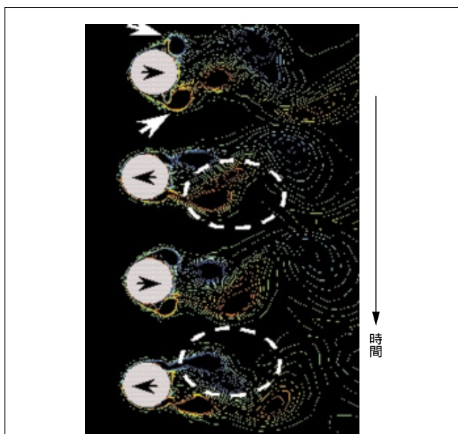
図2. 流体・構造連成振動解析結果 - インライン振動特有の双子渦(白矢印)が後流で結合するようす(白点線枠)が見られる。(黒矢印: 管の振動方向) Flow-induced vibration analysis
