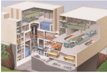
図2 . 800 MWe 級 ABWR の概念 - しきい値効果を採用した低出力型 ABWR の概観。物量低減によりスケールデメリットを克服する。
