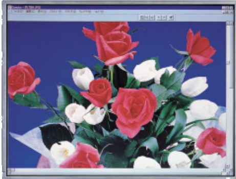
量産を開始した14.1型低温p-Si TFT-LCD (LTM14C501S型) 14.1-inch low-temperature p-Si TFT-LCD
