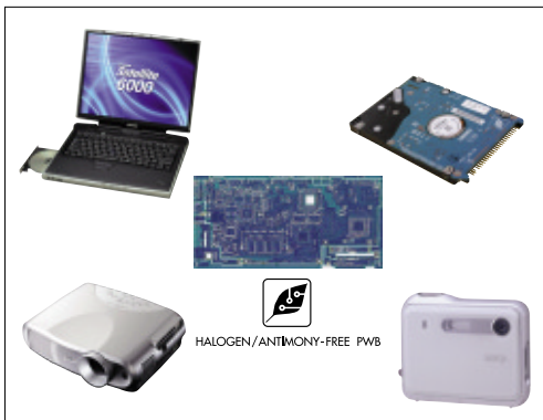
環境調和型多層プリント配線板(中央)と採用した電子機器 Environmentally conscious multilayer printed wiring board (center) and electronic devices
