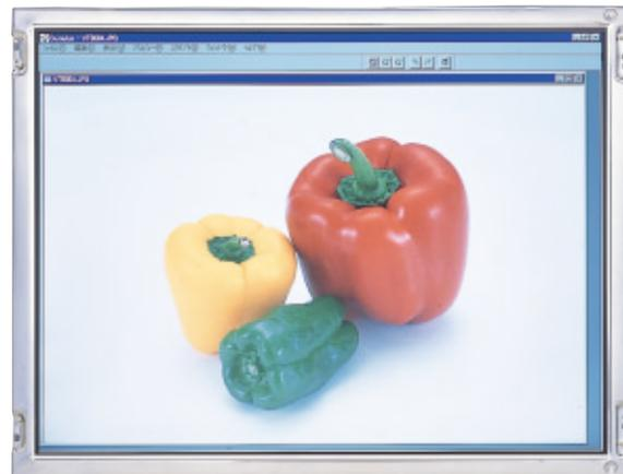
モニター用15型XGA TFT-LCD LTM15C458
